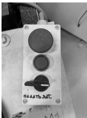
Рис. 6. Пульт управления подачей заготовок на станки с числовым программным управлением
